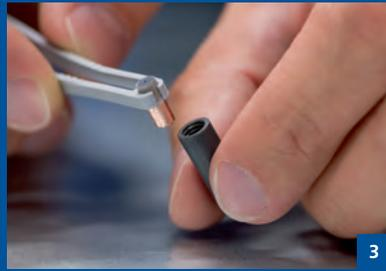
**Abb. 3:** Probe mit Graphittiegel für Analyseofen, Foto: utg/Hase
