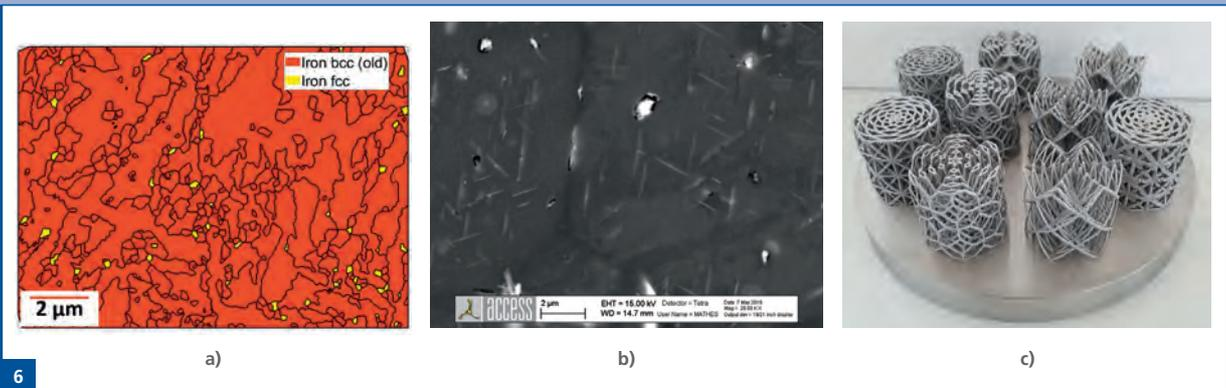
**Abb. 6:** a) 1.2343 as-built, tempered at 550 °C, 4 h Martensit, Restaustenit (RA)~0.3 % (Doi.org/10.3390/jmmp6030063), b) T1-Ausscheidungen in der AlCu-Li-Legierung AA2099 (DOI:10.3390/ma13225188), c) AlSi10Mg-Geometrien
