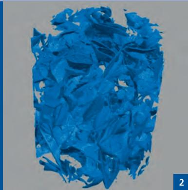
**Abb. 2:** n-CT-Tomographie eines groben A-Graphit Netzwerks.
