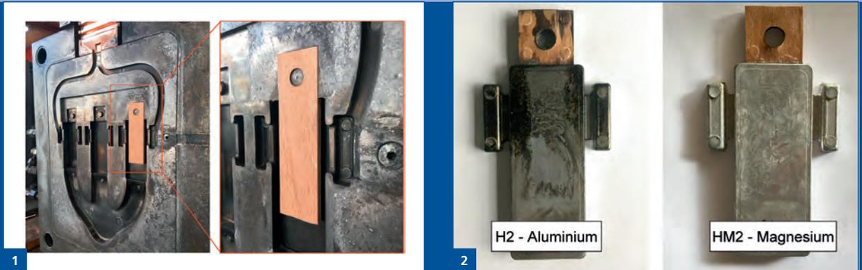
**Abb. 1:** Fixiertes Holzeinlege- und Druckgießform.
