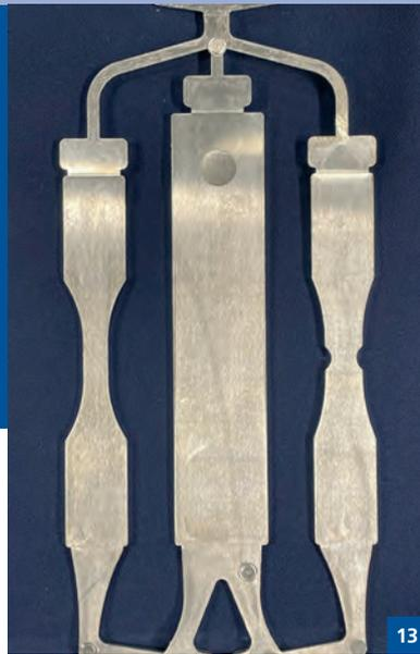
**Abb. 13:** Probengeometrie für ungekerbte und mild gekerbte Flachproben
