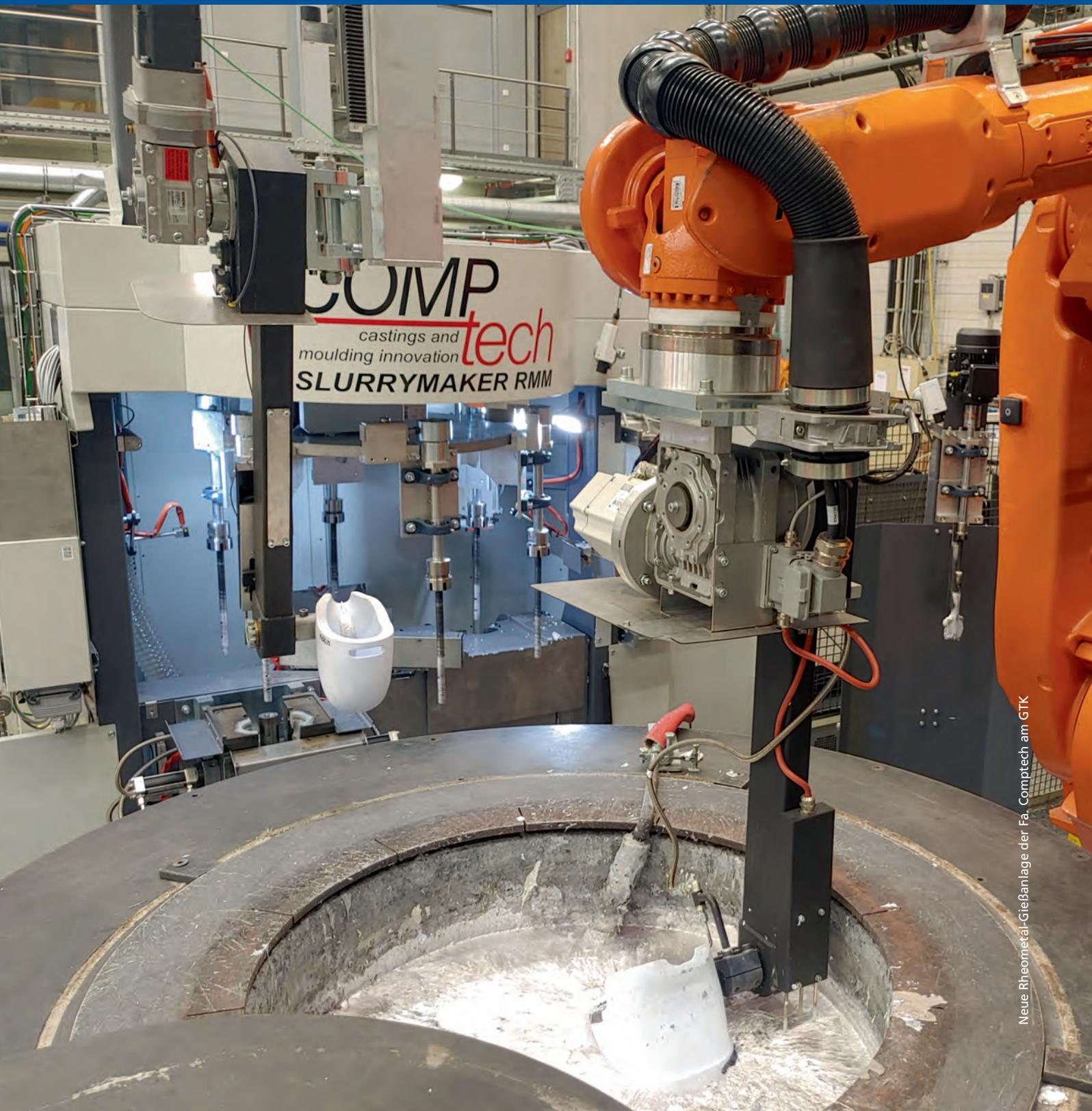
**Abb. 1:** Metakushalle – Gießtechnikum des GTK in Baunatal. Von links nach rechts: Bühler 1.400t Kaltkammer Druckgießanlage mit Rheometal-Anlage, Frech Mg-Warmkammer Druckgießzelle 220 t, Yizumi Mg-Thixomoldinganlage 1.250 t, ExOne S-Max Pro 3D-Sanddrucker für anorganische Formen und Kerne.
