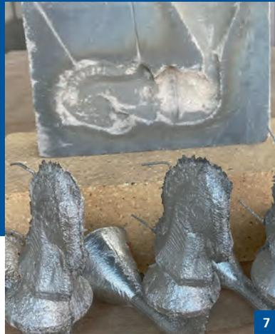
**Abb. 7:** Faserverstärkte Sandgussform nach vier Abgüssen, Foto: Fraunhofer IGCV
